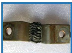
腐蚀后的软连接
