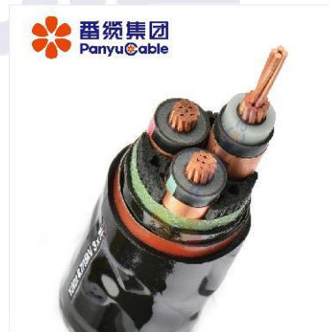
铜交联聚乙烯绝缘钢带铠装聚氯乙烯护套电力电缆 YJV
