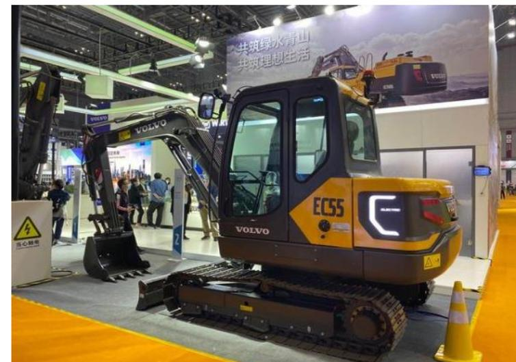
沃尔沃电动履带式挖掘机——11kW OBC
