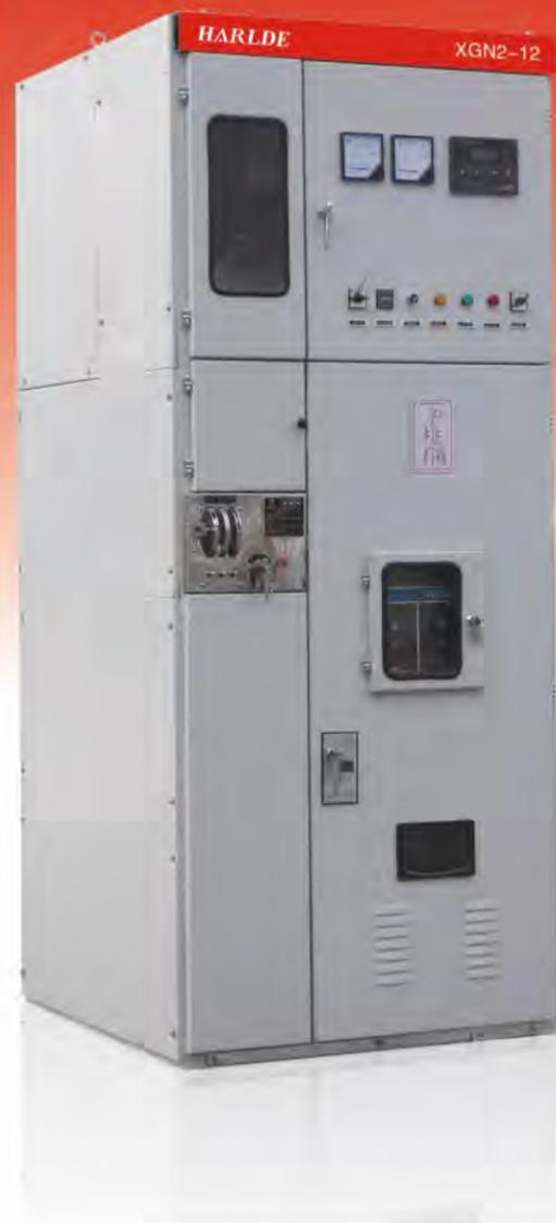
XGN2-12(Z)箱型固定式交流金属封闭开关设备(简称“开关设备”),适用于额定电压3.6~12kV、50Hz,额定电流630A~3150A的三相交流单母线、双母线、单母线带旁路系统,作为接受和分配电能之用,可满足各种发电厂、变电站(所)及工矿企业使用要求。
