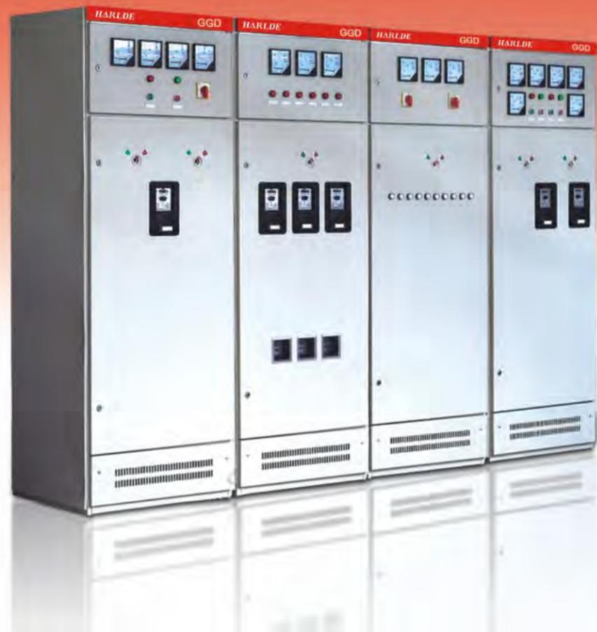
变电所、工矿企业等电力用户作为交流50HZ，额定工作电压380V，额定电流至3150A的配电系统中作为动力，照明及配电设备的电能转换、分配与控制之用。该产品分断能力高，额定短时耐受电流达50kA。线路方案灵活、组合方便、实用性强、结构新颖等特点。该产品是我国组装式、固定面板开关柜的代表产品之一。
