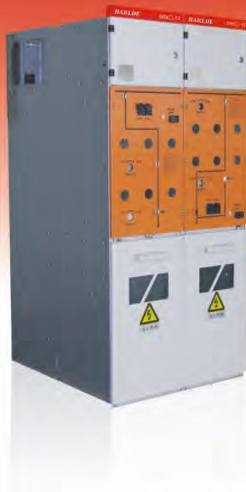
SRK□-12系列固体绝缘开关组装置应用于新一代紧凑型固体绝缘环网柜中，是完全不使用SF6温室气体的一种全绝缘、全密封、免维护的固体绝缘真空开关设备。所有高压带电部分均用绝缘性能优良的环氧树脂材料浇注成型，将真空灭弧室、主导电回路、绝缘支撑等有机结合为一整体，功能单元通过全绝缘固体汇流母线连接。因此，整个开关设备不受外部环境影响，可确保设备运行的可靠性和操作人员的安全性。
