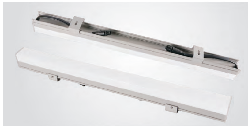
产品型号: YJ-3741轮廓灯 灯具尺寸: 37*41*1000MM 光源: Cree/Osram/Epistar/Bridgelux 额定功率: 12W 输入电压: DC24V 灯具材质: 6063航空拉伸铝 带PC高亮透光罩 光色: 1800K-7500K, 全系单色光, RGB, RGBW 表面处理: 户外等级喷涂, 常规UV 10年保护/硬质阳极氧化 IP等级: IP65
