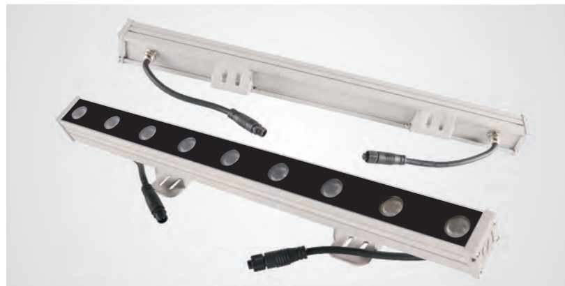
产品型号: YJ-3835洗墙灯 灯具尺寸: 38*35*1000MM 光源: Cree/Osram/Epistar/Bridgelux 额定功率: 18W/24W/36W 输入电压: DC24V 灯具材质: 6063航空拉伸铝 纯结构防水灯具 光色: 1800K-7500K, 全系单色光, RGB, RGBW 表面处理: 户外等级喷涂, 常规UV 10年保护/硬质阳极氧化 IP等级: IP65
