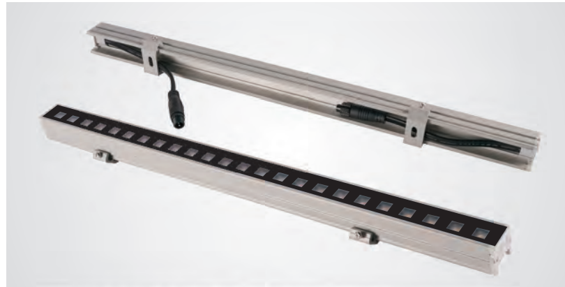
产品型号: YJ-2826线条灯 灯具尺寸: 28*26*1000MM 光源: Cree/Osram/Epistar/Bridgelux 额定功率: 12W/15W 输入电压: DC24V 灯具材质: 6063航空拉伸铝 半结构防水灯具, 光色: 1800K-7500K, 全系单色光, RGB, RGBW 表面处理: 户外等级喷涂, 常规UV 10年保护/硬质阳极氧化 IP等级: IP65
