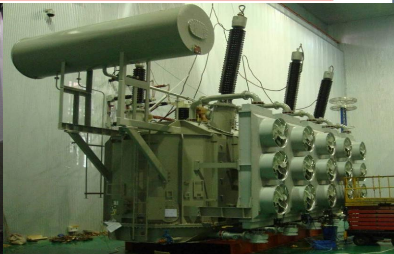
SFP10-420000/220电力变压器做温升试验
