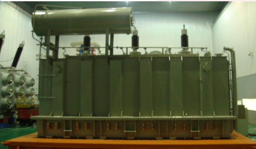
ZHSB-ZF-4920/6.3 中船重工712所海上平台动力试验系统用蒸发冷却整流变压器
