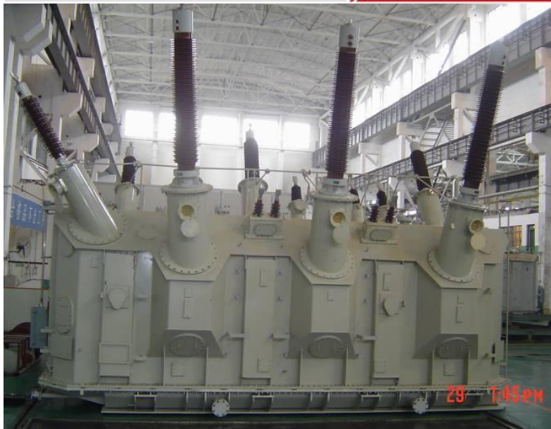
SFPSZ10-180000/220带平衡线圈 (内蒙古呼市云中变)
